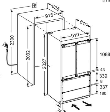
Inklusive 3 m Panzerflexschlauch für Festwasseranschluß 3/4"
