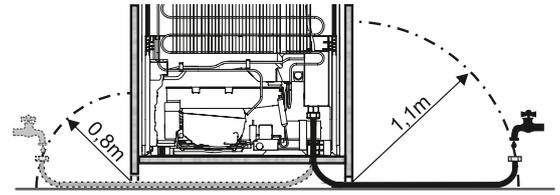
Festwasseranschluss für automatischen Eiswürfelbereiter notwendig (3/4")!
