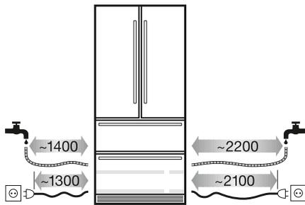
Festwasseranschluss für automatischen Eiswürfelbereiter notwendig (3/4")!
