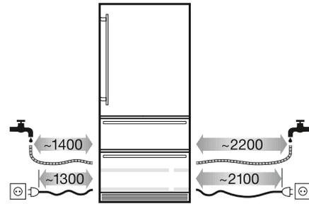
Festwasseranschluss für automatischen Eiswürfelbereiter notwendig (3/4")!
